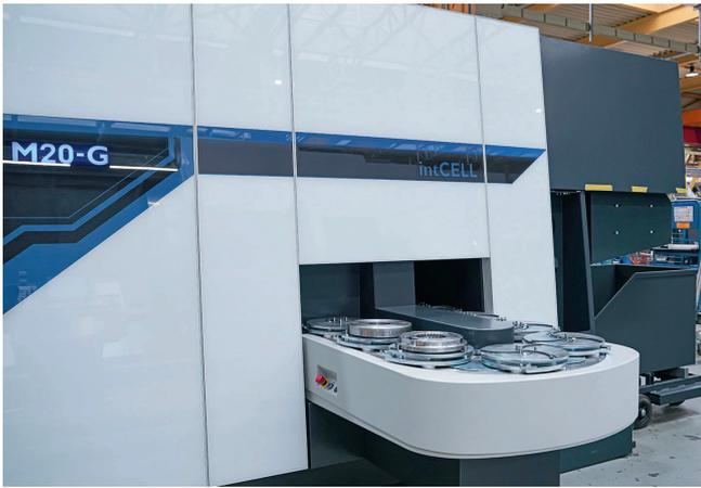
2 intCell: integrierte Fertigungszelle für die automatische Be- und Entladung an der 'M20-G' © WFL
